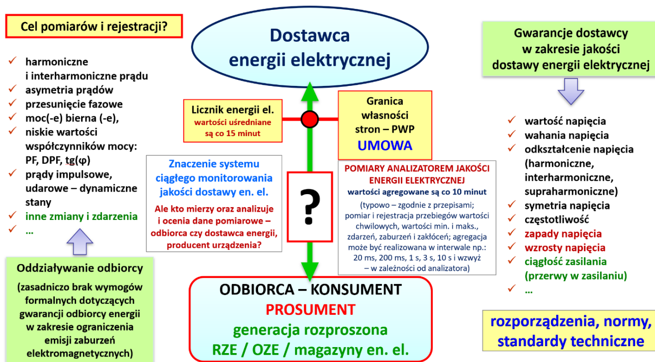
Rys. 1 Znaczenie systemów monitorowania parametrów pracy sieci zasilających z uwzględnieniem W-JDEE oraz procedur ustalania odpowiedzialności za pogorszoną JDEE [P.2]-[P.5], [P.14], [P.18], [P.20], [P.38]-[P.45], [P.50]
