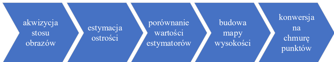
Rys. 4.1. Schemat przetwarzania danych w klasycznej metodzie SFF
