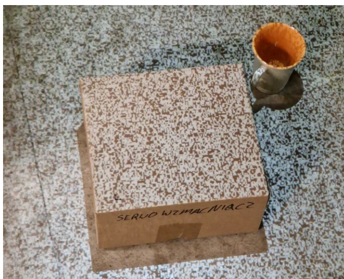
Rys. 3.7. Projektcja światła strukturalne w formie kodu dwuwymiarowego matrycowego
