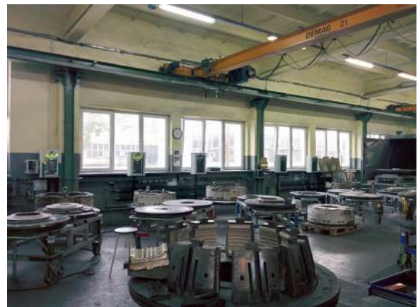
(d) stanowiska do czyszczenia form
