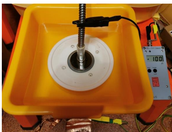
Rys. 6.15 Skalowanie toru pomiarowego: a) podłączony generator ładunków skalujących (ładunek skalujący 100 pC; b) okno programu ICMsystem podczas procedury skalowania toru pomiarowego
