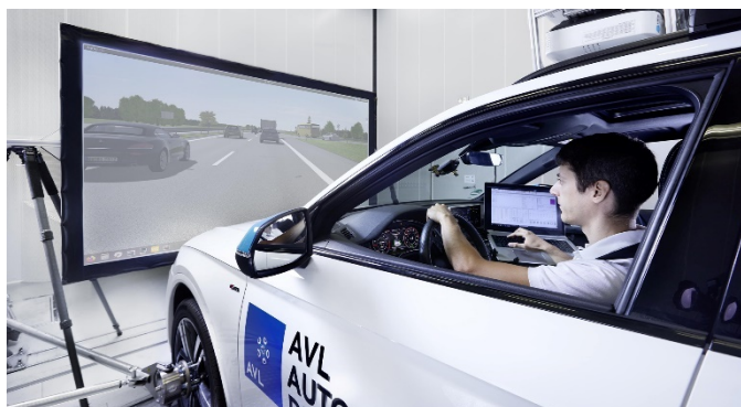
Rys. 64. Stanowisko testowe do bezprzewodowej stymulacji kamery za pomocą ekranu [274].
