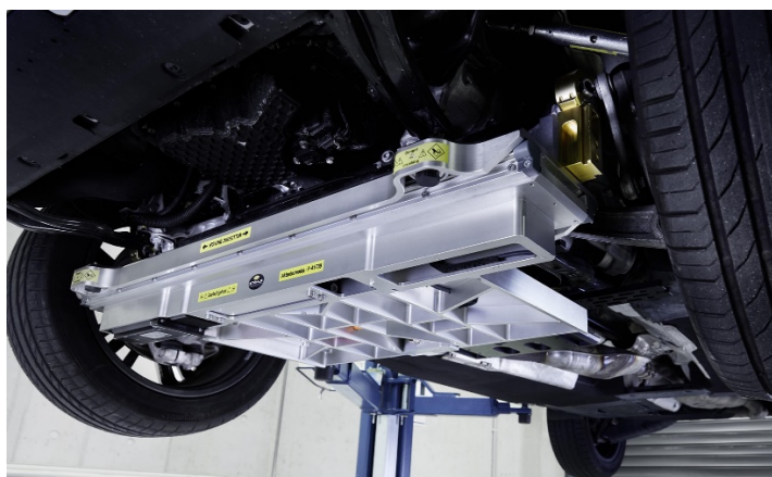
Rys. 93. Emulator dynamicznej siły kierowania [274].
