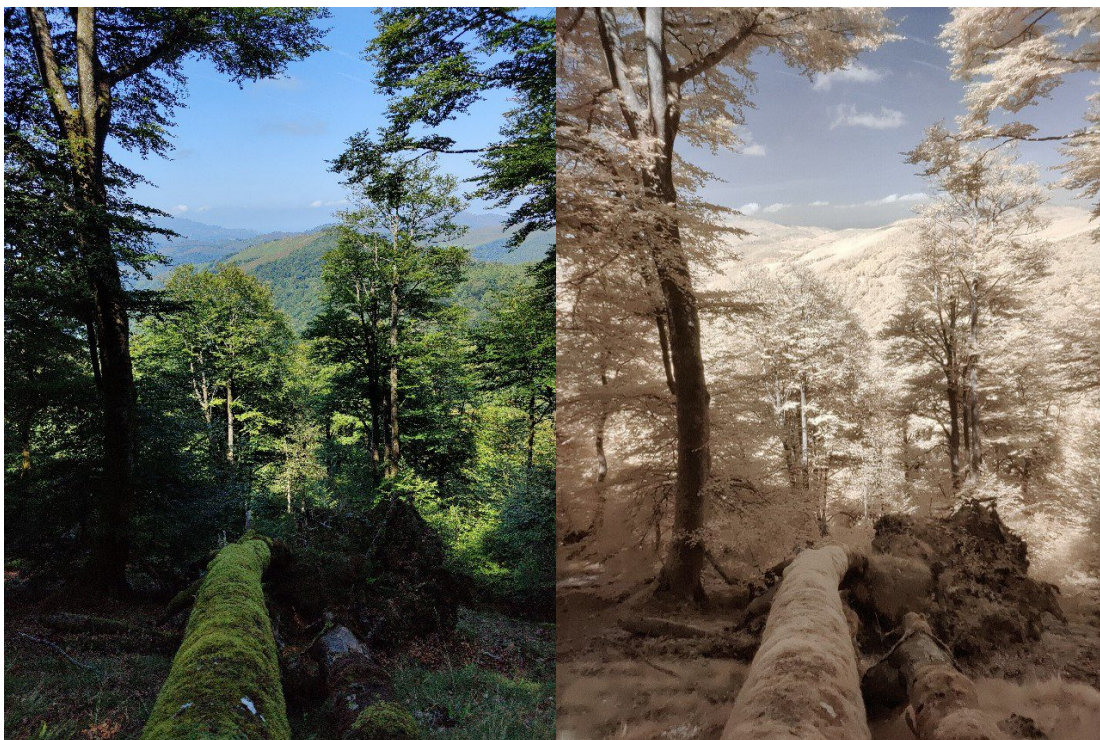
Rys. 29. Porównanie obrazów zarejestrowanych w dzień przez kamerę kolorową po lewej i kamerę bliskiej podczerwieni po prawej [113].
