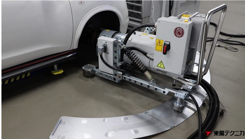
Rys. 94. Hamownia dynamometryczna z możliwością skrętu kół [371].
