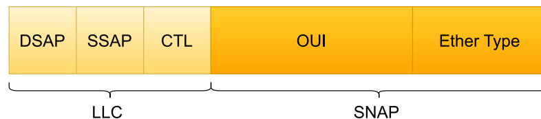
Rys. 61. Ramka składająca się z nagłówka LLC oraz następującego po nim nagłówka SNAP.
