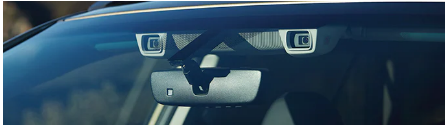
Rys. 31. Kamera stereo wchodząca w skład systemu Eyesight firmy Subaru [127].
