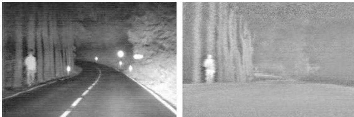
Rys. 30. Porównanie obrazów zarejestrowanych w nocy przez kamerę bliskiej podczerwieni po lewej oraz przez kamerę termowizyjną po prawej [104].
