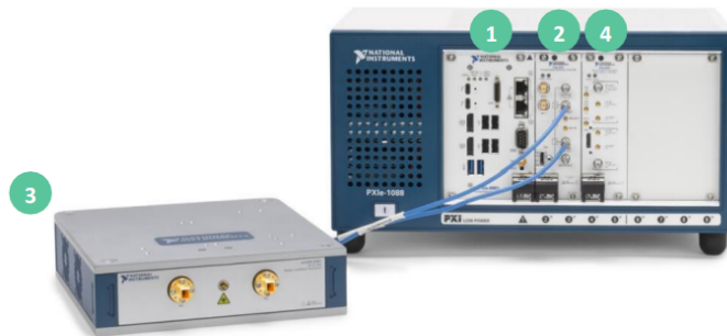
Rys. 81. Simulator celu radarowego z głowicą nadawczo-odbiorczą [310].
