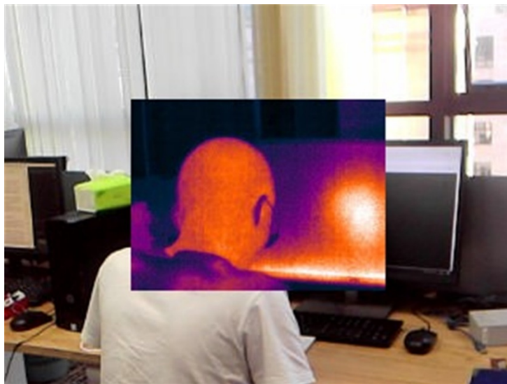
Rys. 65. Obraz kamery termowizyjnej z widocznym niejednorodnym rozkładem temperatury w obrębie monitora [278].
