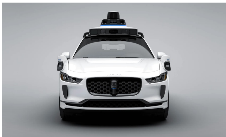
Rys. 50. Samojedna wersja elektrycznego Jaguara I-Pace wyposażona w lidar mechaniczny umieszczony na dachu [206].
