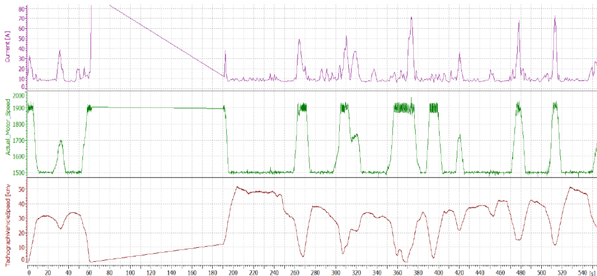
Rys. 2.2. Przebieg wartości prądu inwertera, prędkości obrotowej pompy, prędkości pojazdu w funkcji czasu podczas testu jezdnego po Murowanej Goślinie, pierwsza oś obciążona jak przy dopuszczalnej masie całkowitej (DMC), zakres pracy pompy 1900/1500 obr/min
