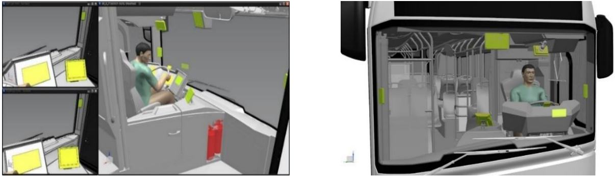
Rys. 2.12. Wizualizacje kabiny kierowcy z wyszczególnionymi lokalizacjami HMI [16]
