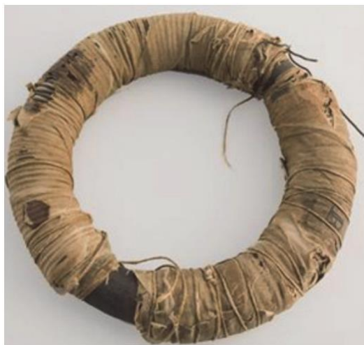
Rys. 3.1 Pierwszy transformator toroidalny zbudowany przez Michaela Faradaya [115]
