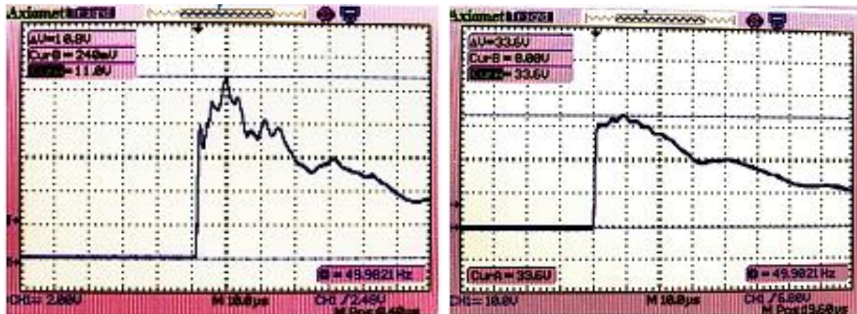
Rys. 7.5 Zarejestrowany przebieg napięcia międzywarstwowego (a) oraz doziemnego (b)
