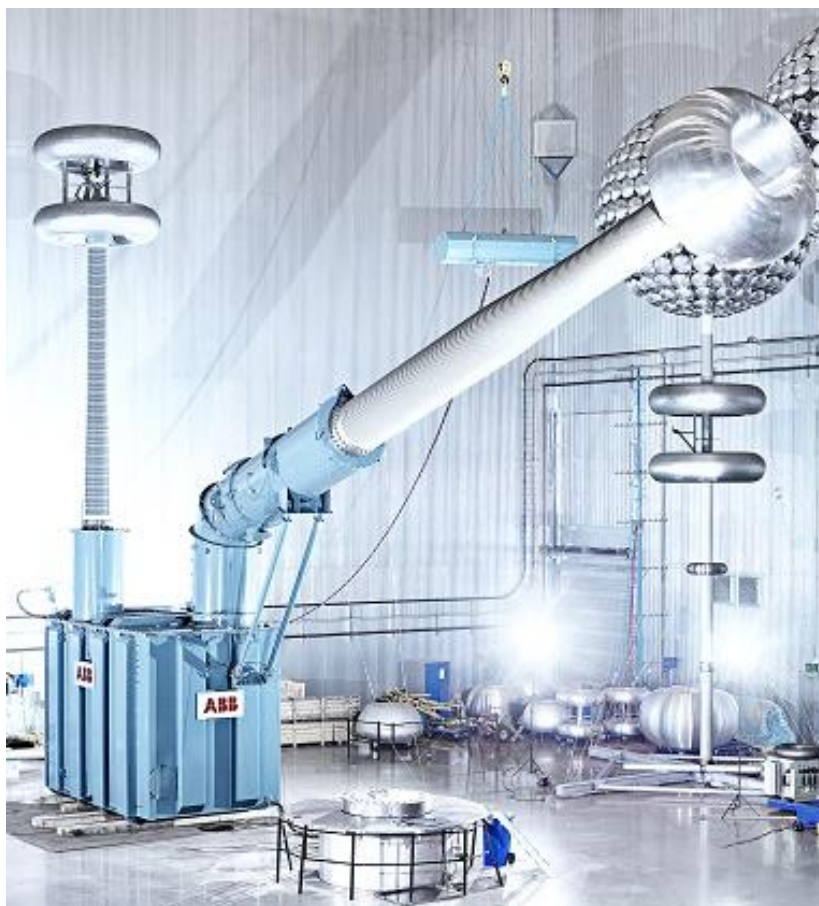
Rys. 3.6 Transformator HVDC produkcji ABB na stacji prób [212]
