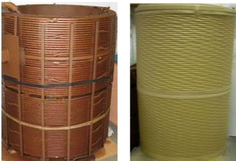
Rys. 8.1 Zdjęcia eksperymentalnych uzwojeń transformatora 25 MVA: a) uzwojenie cewkowe wysokiego napięcia 110 kV, b) uzwojenie warstwowe średniego napięcia 15 kV [169]
