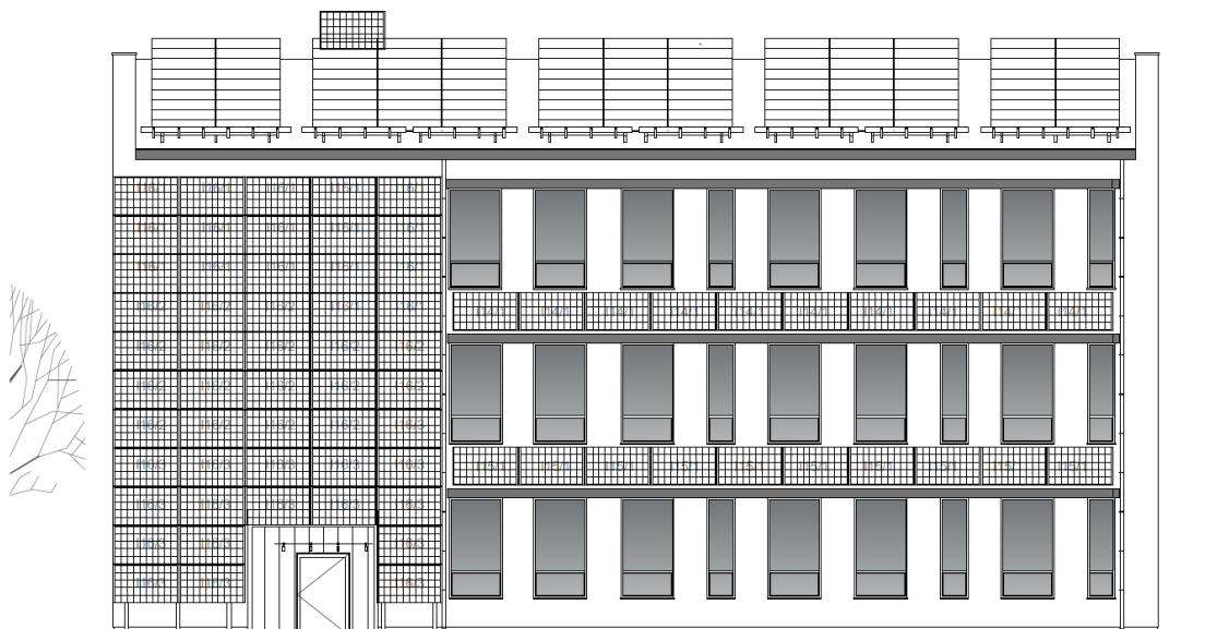
Rys. 4.48 EC Budynek nr. 11, rozmieszczenie paneli PV - Elewacja
