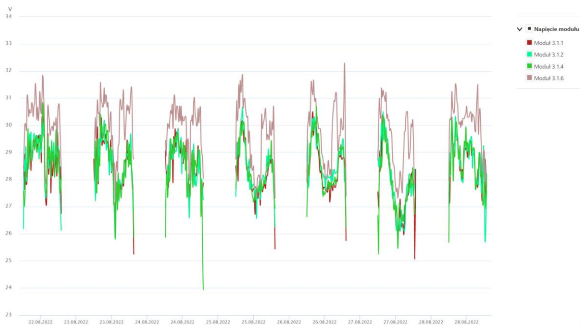
Rys. 5.22 Tygodniowe porównanie przebiegu napięcia modułów z białą i czarną ramką 260 [Wp] [151]
