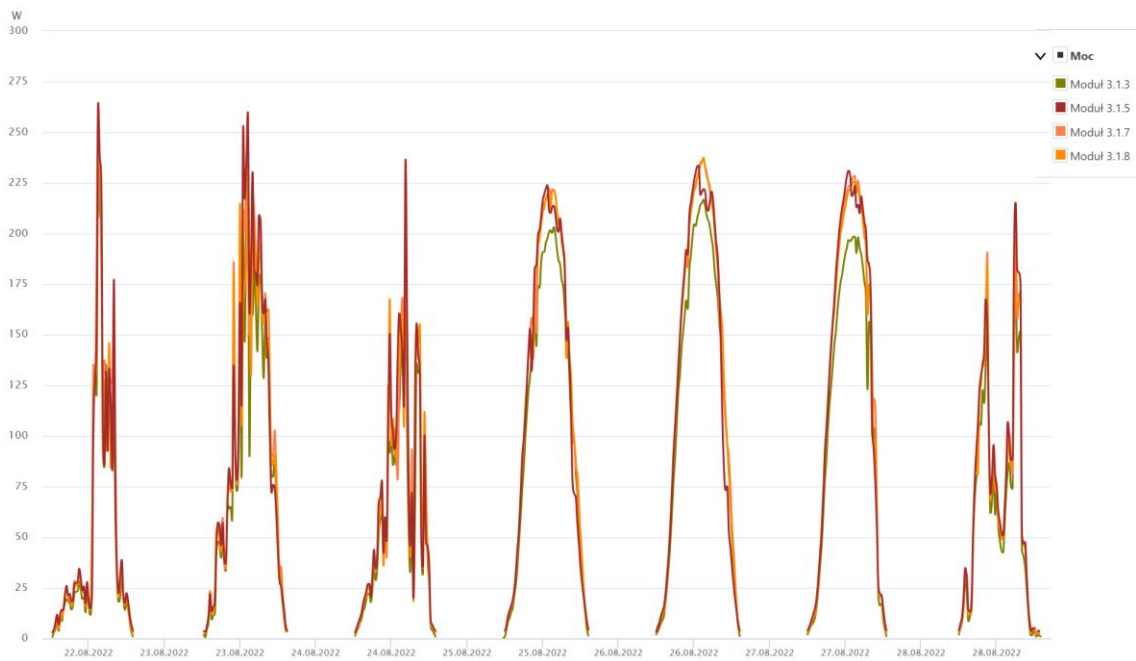
Rys. 5.32 Tygodniowe porównanie przebiegu mocy dla modułów z białą i czarną ramką 285 [Wp] [151]
