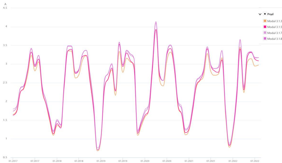
Rys. 5.27 Porównanie przebiegu prądu dla modułów z białą i czarną ramką 285 [Wp], cały okres pomiarowy [151]
