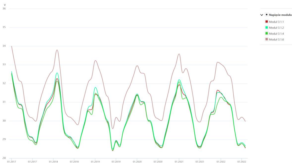
Rys. 5.21 Porównanie przebiegu napięcia modułów z białą i czarną ramką 260 [Wp], cały okres pomiarowy [151]
