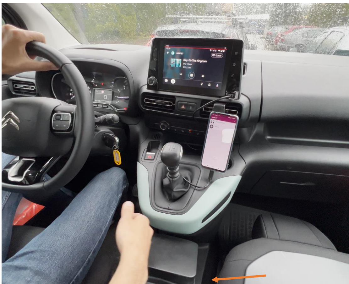
Rysunek 42. Implementacja systemu w samochodzie. Strzałką oznaczono lokalizację zabudowanej elektrody
