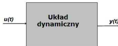
Rys. 1.6. System dynamiczny ułamkowego rzędu, gdzie u(t) - wejście systemu, y(t) - wyjście systemu
