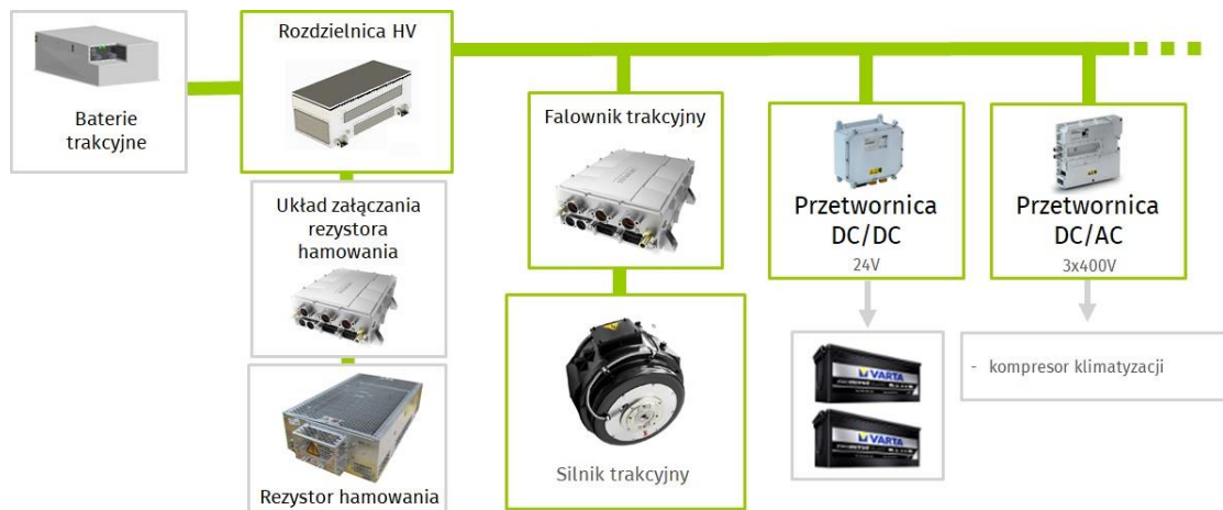
Rys. 10. Schemat ideowy modułowego elektrycznego układu napędowego Źródło: opracowano na podstawie [4]
