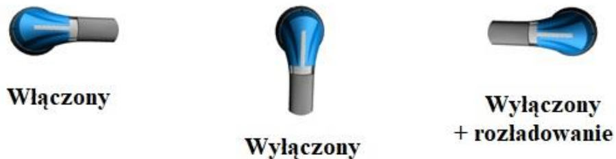
Rys. 32. Pozycje ręcznego rozłącznika zasilania zlokalizowanego na rozdzielnicy „HV BOX” Źródło: [4]
