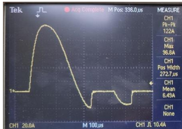
Rys. 47. Pomiar przebiegu prądu w momencie zamknięcia stycznika K1 Źródło: opracowanie własne
