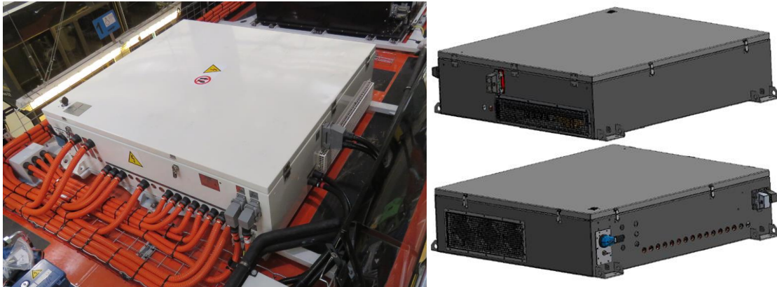
Rys. 7. Zewnętrzna obudowa scentralizowanego układu energoelektronicznego Źródło: opracowano na podstawie [4]
