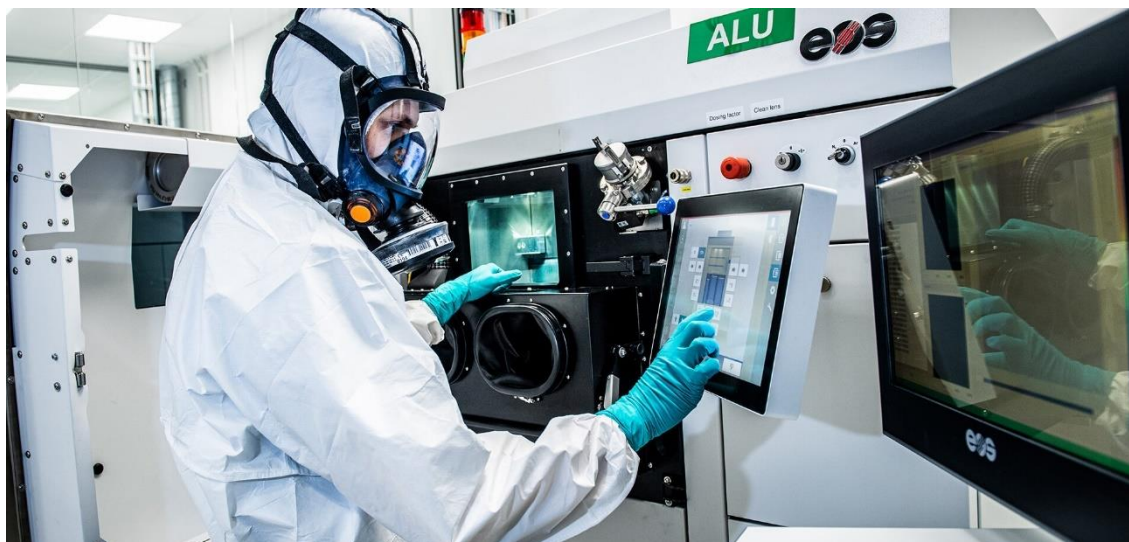
Rys. 5-10 Pracownik wyposażony w maskę pełnotwarzową, rękawice oraz kombinezon podczas pracy przy urządzeniu pracującym w technologii łoża proszkowego (SLM) [106]
