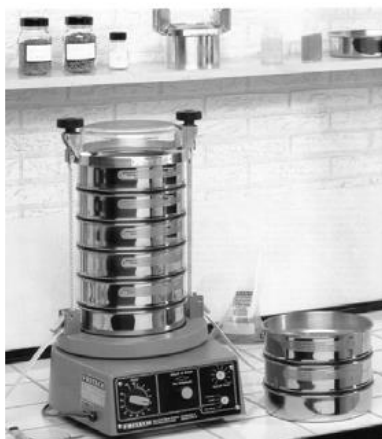
Rys. 3-4 Wibracyjna wstrząsarka sitowa „Spartan” – do metody mokrej i suchej (zakres stosowania do pyłów o wielkości ziaren z przedziału 20 \mu\text{m} do 2500 \mu\text{m} ) [30]
