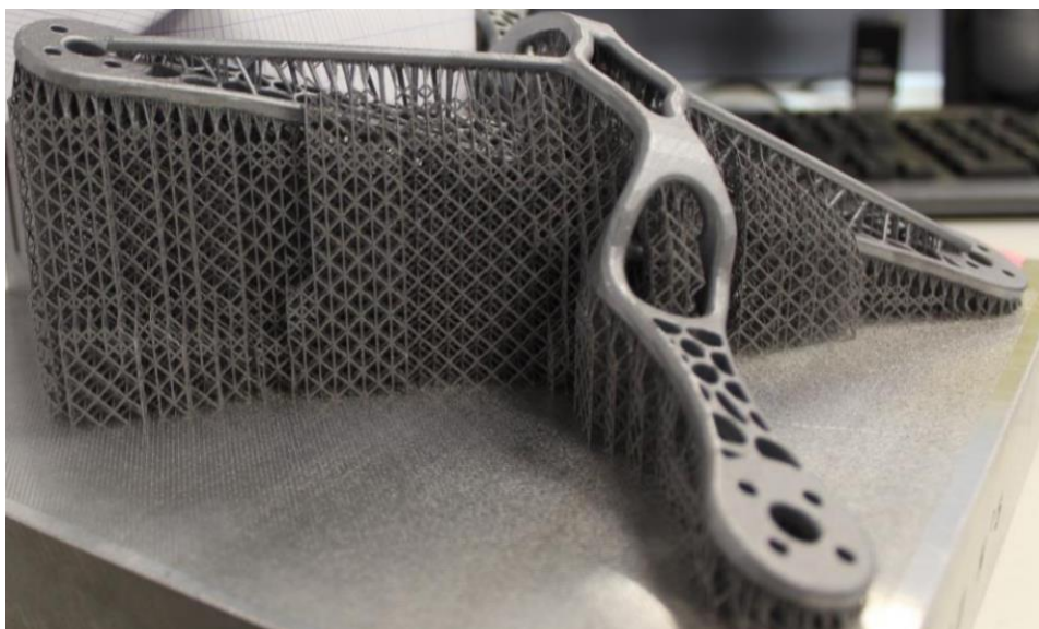
Rys. 4-10 Rama drona wykonana w technologii SLM przytwierdzona do płyty bazowej za pomocą podpór [99]
