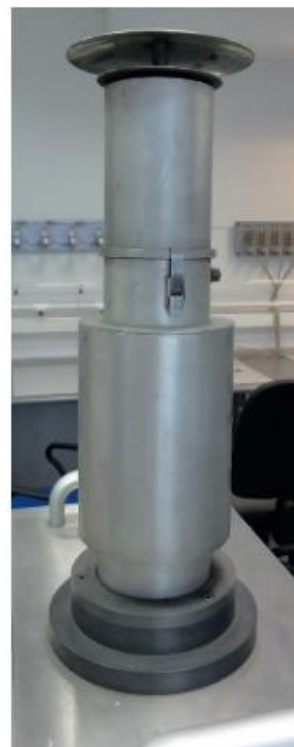
Rys. 3-2 Przekrój oraz zdjęcie poglądowe głowicy poboru dla pyłu PM 10 i PM 2,5 dla przepływu 2,3 m 3 /h Źródło: PN-EN 12341:2014 [26] (zdjęcie: T. Frączkowski)
