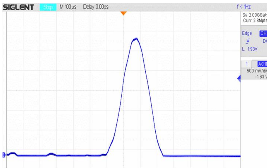
Rys. 17-14 Odpowiedź układu na cząstkę proszku \text{Al}_2\text{O}_3 – napięcie w funkcji czasu
