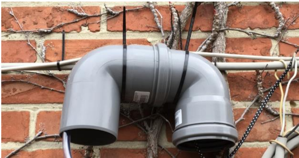
Rys. 3-11 Zmontowany sensor w z projektu Sensor Community / Luft Daten [71]
