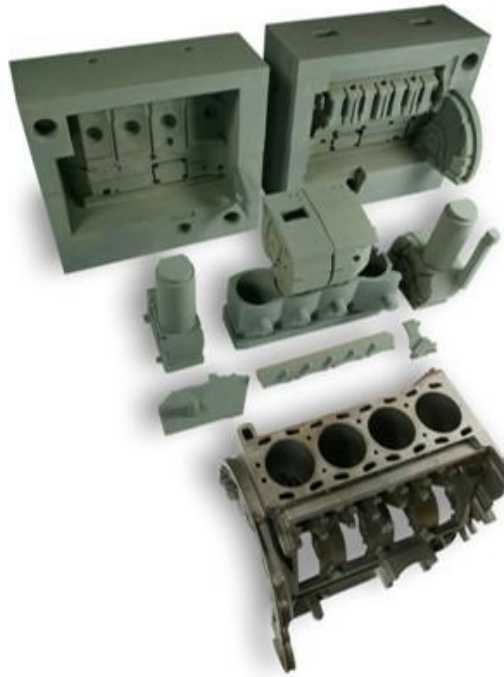
Rys. 4-4 Forma oraz rdzenie wytworzone na urządzeniu firmy Voxeljet z piasku odlewniczego wraz z gotowym odlewem [91]
