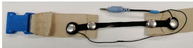
Rys. 12 Prototyp rezystancyjnego czujnika oddechowego [50]
