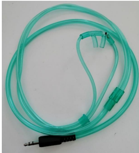
Rys. 8 Termiczna kaniula nosowa zastosowana w prototypie systemu Comarch PulmoVest
