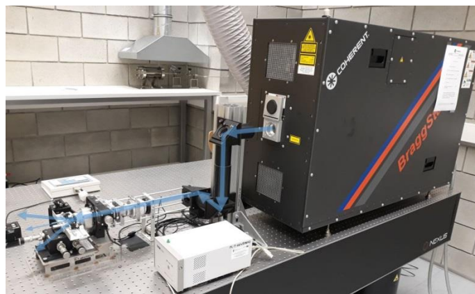
Rys. 5.1. Zdjęcie zaprojektowanego i wykorzystywanego na potrzeby pracy stanowiska do wytwarzania siatek Bragga na włóknach fotouczulonych, niebieskimi strzałkami zaznaczono przebieg wiązki lasera
