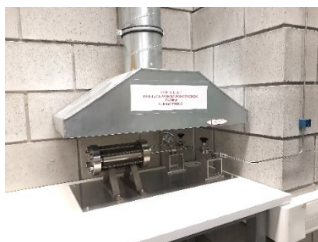
Rys. 6.2. a) Komora do wodorowania włókien, b) system wentylacji i odprowadzania gazów
