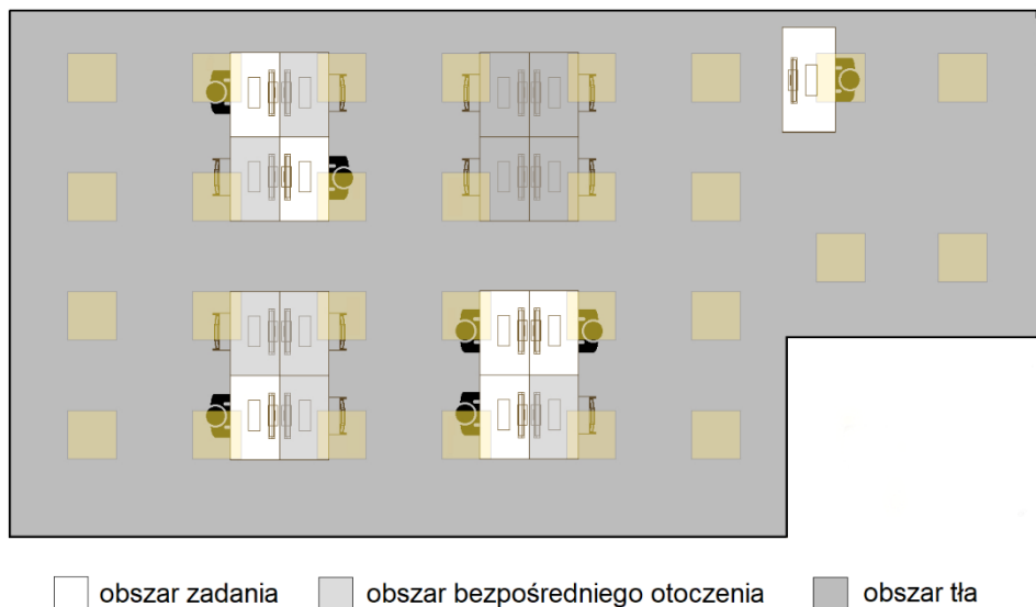
Rysunek 55. Koncepcja określania obszaru zadania, bezpośredniego otoczenia oraz tła podczas lokalnego sterowania oświetleniem w otwartej przestrzeni biurowej.
