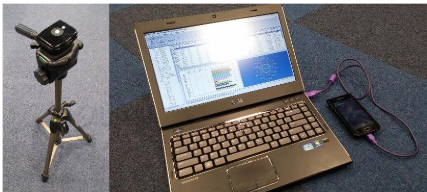
Rysunek 50. Statyw z bezprzewodowym modulem pomiarowym oraz baza miernika SFIM-300 i komputer wraz z oprogramowaniem pomiarowym podczas prowadzenia pomiaru.
