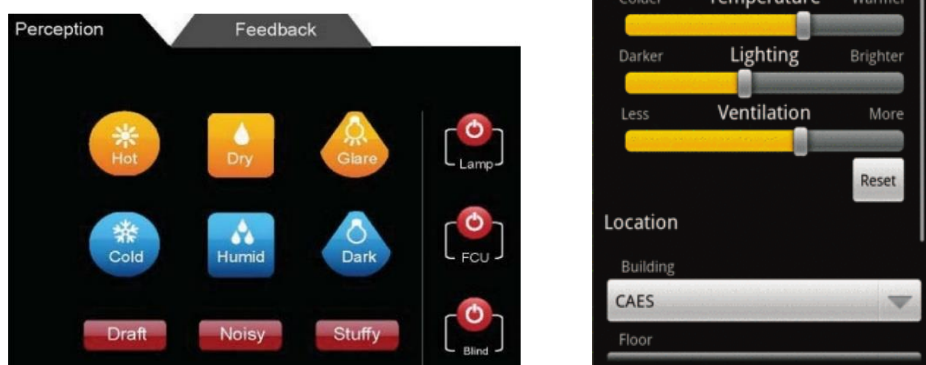
Rysunek 6. Przykładowe, zorientowane na użytkownika interfejsy komunikacji, które umożliwiają przesyłanie do systemu sterowania informacji o odczuciach i preferencjach dotyczących warunków mikroklimatycznych we wnętrzu [58, 80].
