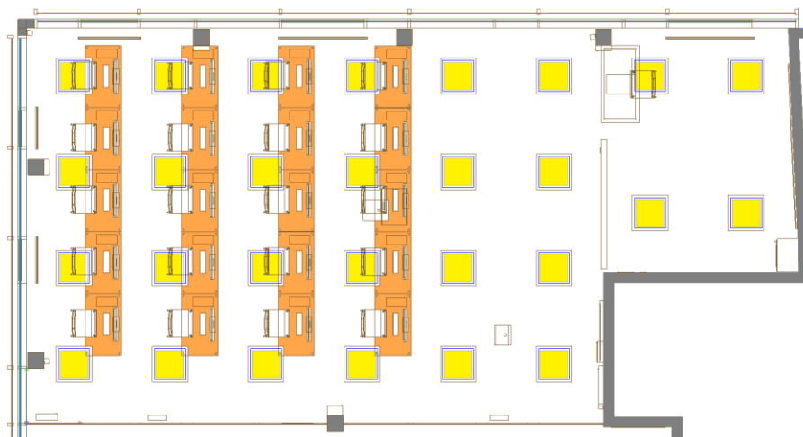
Rysunek 26. Plan pomieszczenia doświadczalnego 3.02 – rozmieszczenie stanowisk pracy (pomarańczowe) względem opraw oświetleniowych (żółte).
