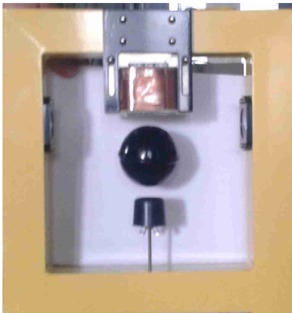
Rysunek 13: Pozycja sfery dla której projektowany był regulator PI^{\lambda}D
