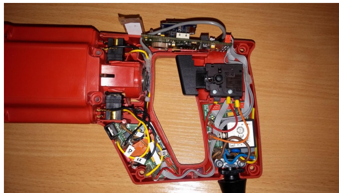
Rys. 3. Sterownik zakrętarki SETT w obudowie napędu.
