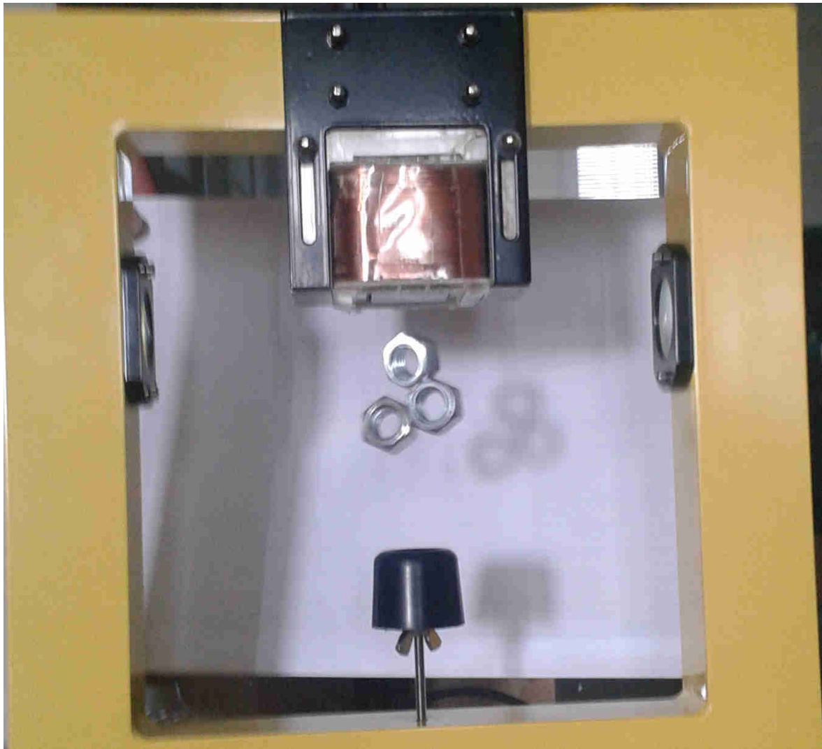
Rysunek 6.21: Nakrętki lewitujące w systemie z regulatorem PI^{\lambda}D
