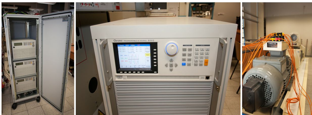
Rysunek 15: Elementy laboratoryjnego modelu systemu: programowalne obciążenia (po lewej), programowalne źródło napięcia (w środku), sterowane obciążenie elektromechaniczne (po prawej). Sprzęt został sfinansowany z dotacji aparaturowej, o którą skutecznie aplikował autor w 2011 roku.
