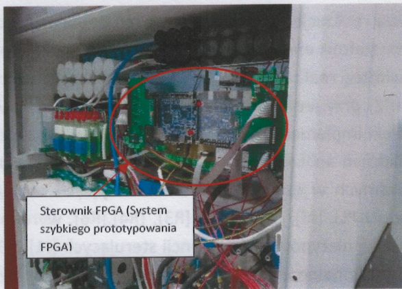
Rys. 2 Zastosowanie Systemu Szybkiego Prototypowania FPGA w Modelu funkcjonalnym Inwertera Solarnego o mocy 125kVA [R18]
