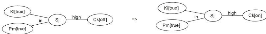
Rysunek 4: Graficzna reprezentacja przykładowej produkcji, która realizuje proces sterowania oświetleniem na grafie CAG; zaczerpnięte z [H6].
