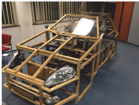
Rys. 11: Prototyp modelu 1:1 systemu elektronicznego samochodu
