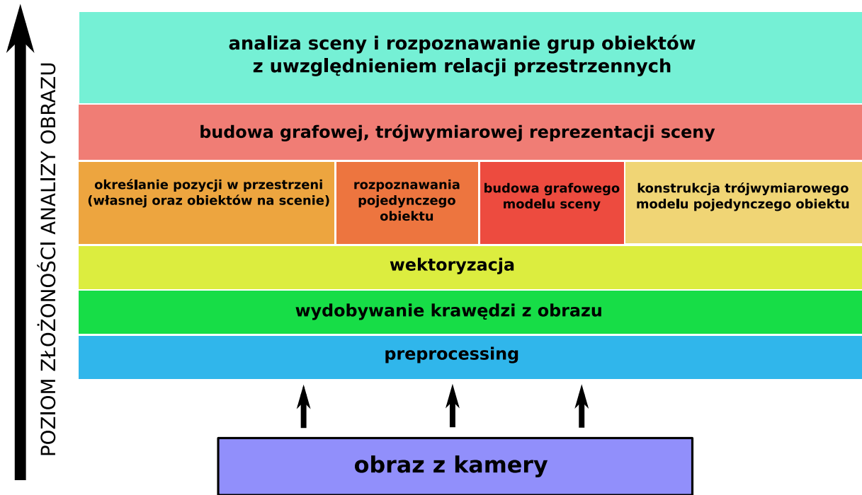
Rysunek 1.1: Schemat logiczny przedstawiający poszczególne etapy przetwarzania obrazów przez proponowany w rozprawie system wizyjny.
