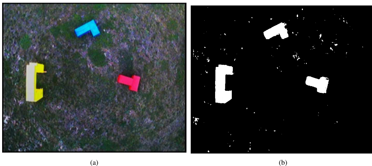
Rysunek 11.5: Obszar sceny sfotografowany przez robota z dużej wysokości, (a) - zdjęcie po preprocesingu, (b) - wyekstrahowane obszary, gdzie znajdują się kolorowe makiety budynków.
