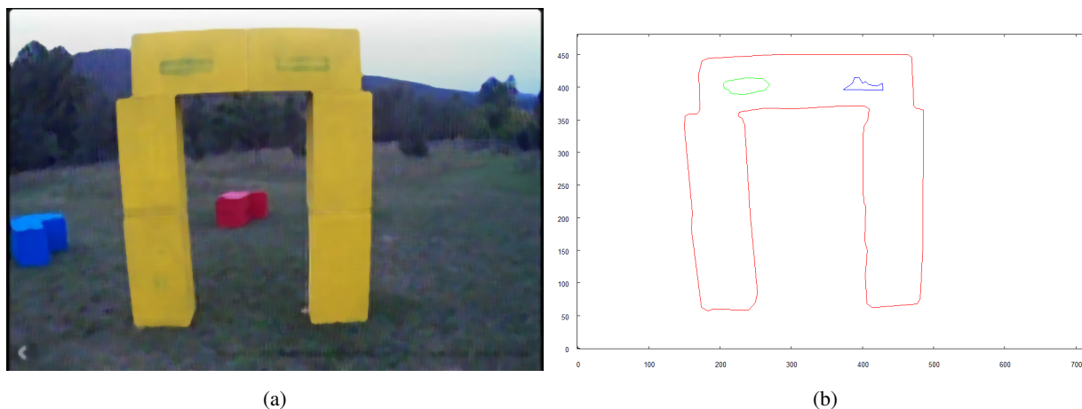
Rysunek 11.13: Obraz analizowanego budynku widzianego przodu, uzyskany przez robota, (a) - obraz po preprocessingu, (b) - obraz wektorowy dla wykorzystania do konstrukcji modelu 3-D.
