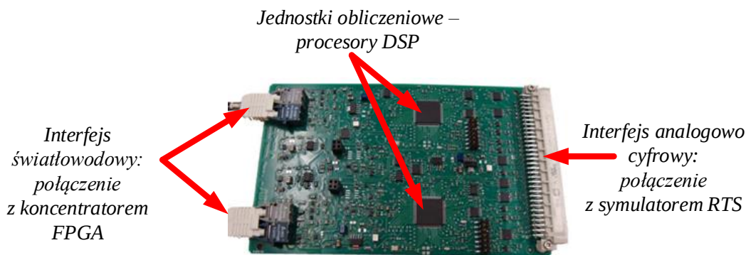
Rys. 79. Zdjęcie obwodu drukowanego zawierającego dwa sterowniki modułowe (Materiały udostępnione przez Korporacyjne Centrum Badawcze ABB w Krakowie).
