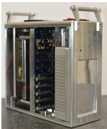
Rys. 3.14. Widok modułu kamery, zaprojektowanej na bazie układu scalonego XPAD3 [44].
