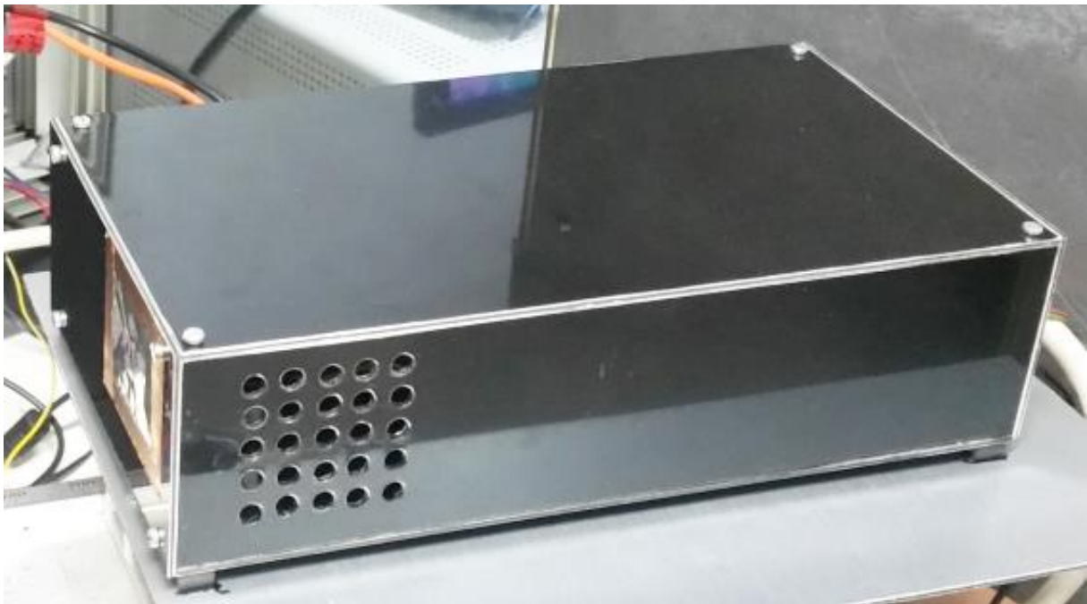
Rys. 6.12. Moduł kamery zamontowany w prototypowej obudowie umożliwiającej przeprowadzenie testów z wykorzystaniem promieniowania X.
