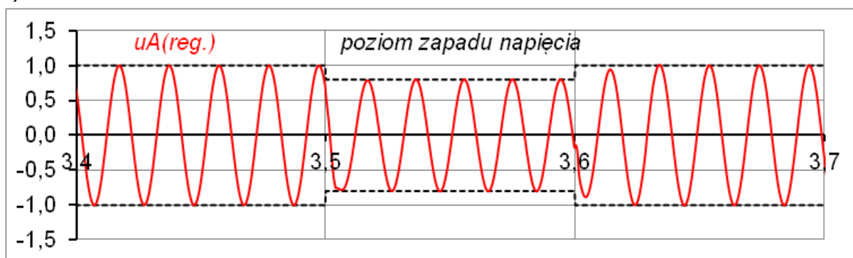
Rys.2.19. Przebiegi u_A , u_B , u_C , u_{DC} układu elektromechanicznego z silnikiem indukcyjnym zasilanym przez idealne źródło napięciowe, podczas zapadów napięcia typu A 90%. Wartość \Psi_r^* wg skorygowanej funkcji amplitudy napięcia zasilania
