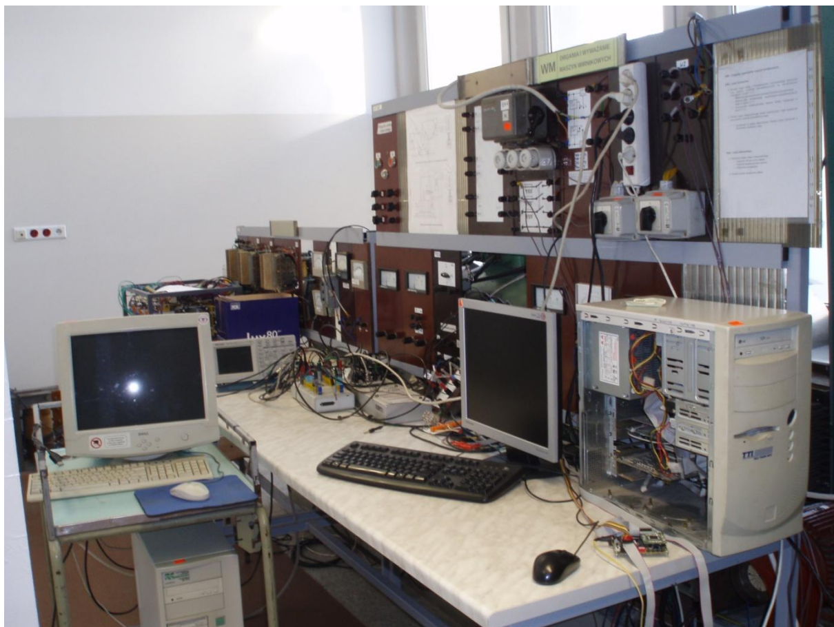
Rys.3.1. Stanowisko pomiarowe układu elektromechanicznego z silnikiem indukcyjnym
