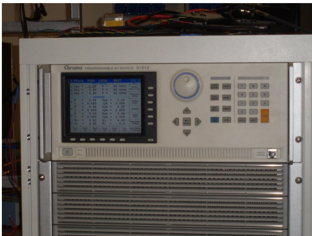
Rys.3.2. Generator CHROMA wykorzystany do symulacji zapadów napięcia typów A – G wg klasyfikacji Bollena oraz przerw w zasilaniu
