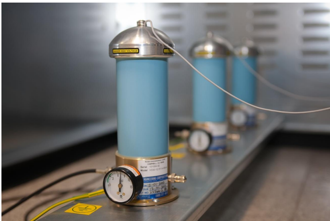
Rys. 6.11 Rezystancyjny dzielnik napięcia o maksymalnym błędzie wynoszącym 1% w zakresie częstotliwości do 1MHz (VD).
