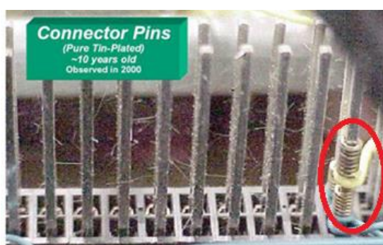
Rys. 4.12 Efekt tin whiskers czyli widoczne „wąsy”, które powodują zwarcie pomiędzy poszczególnymi pinami złącza. W czerwonym kółku można zobaczyć tzw. połączenie owijane, często spotykane w urządzeniach przemysłowych. www.gearslutz.com
